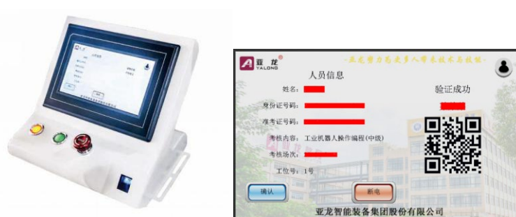
图 5-3 指纹上电模块与系统界面
